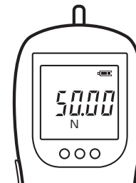
計測軸を上に向けた時 表示される方向
