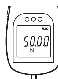
测量轴朝下时 显示的方向
