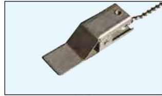
225 细金属线等小负荷试验用夹具
